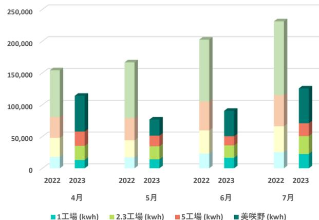
2022年と2023年の4～7月の電気使用量の推移を比較すると、暑くなるにつれ徐々に増加傾向となることがわかります。2023年4月は5月以降に比べて受注量が多かったため、それに伴い電気使用量が多くなったことが考えられます。工場の電気使用量の内訳は生産設備83%、空調9%、照明8%となっており(資源エネルギー庁)、池松機工もほとんどの使用量を生産設備が占めています。そこをいかに削減できるかが重要になりますが、当社は省エネ仕様の生産設備を多く導入しています。加工していないときは不要な周辺機器をこまめに停止することで、消費電力を大幅に削減できるエコアイドルストップ機能に加え、省エネ効果を確認できるエコ電力モニタやインバータ制御を搭載しており、電力削減や生産活動に大いに活躍してくれています。少しでも出費を抑え、利益アップを目指しましょう！
