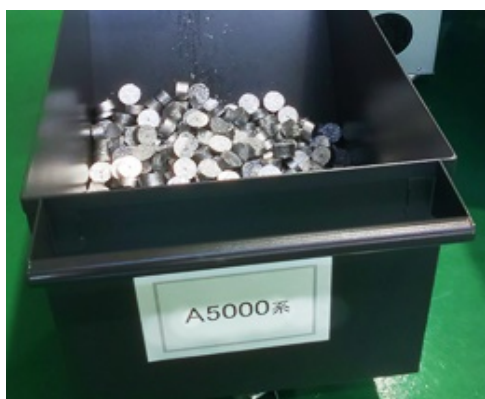
（切粉圧縮機で丸く固めた金属くずと材質表示）
