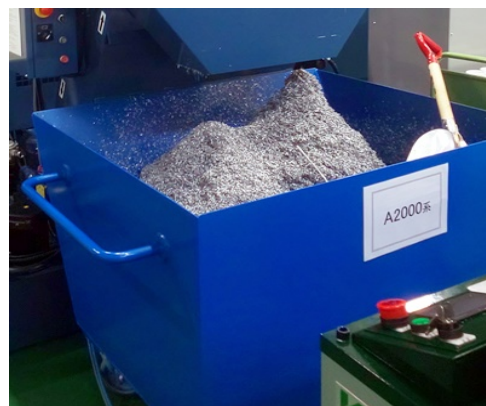
（切削直後の金属くずと材質表示）
